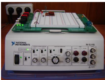
Рис. 1. Рабочая станция NI ELVIS с макетной платой
