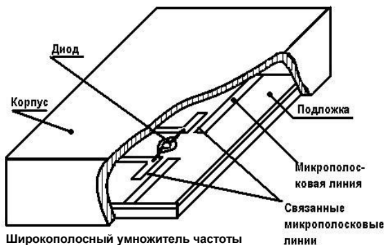
Рис. 19. Интегральная схема в микрополосковом исполнении
