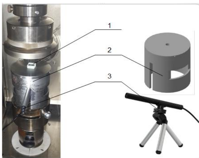
Рис. 6. Схема установки в камере испытательной машины Zwick/Roell Z100: 1 – стеклянный образец размерами 20x20x10 мм; 2 – стальная защита камеры; 3 – USB-микроскоп высокого разрешения
