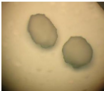
Рис. 6 - Хромит меди на носителе гранулы оксида алюминия (увеличение *10)
