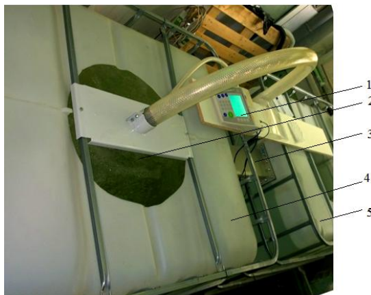
Рис. 1 - Общий вид экспериментальной установки для безреагентной очистки сточной воды комбината общественного питания
